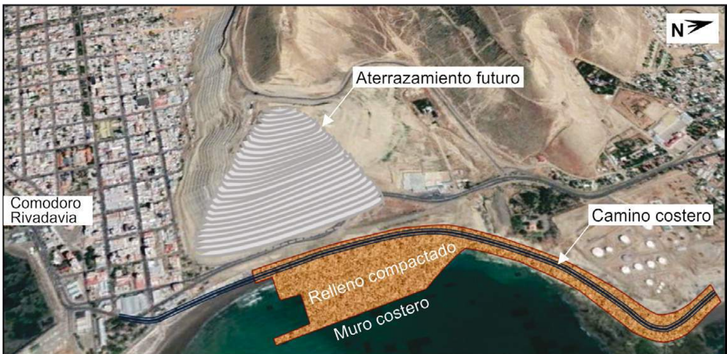
Figura 16. Recreación (esquemática) de cómo podría ser el aspecto del espacio costero consolidado para urbanizar con el relleno del material extraído para estabilizar el faldeo este del cerro Chenque. Imagen de Google Earth™.
