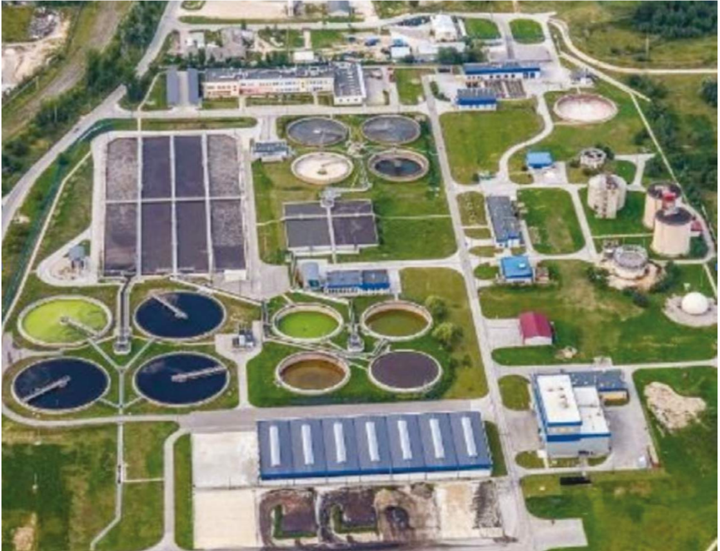
Figura 4. Sistema de Tratamiento de aguas residuales. Fuente: https://ecoinventos.com/planta-italiana-tratamiento-aguas-residuales-autoconsumo/
