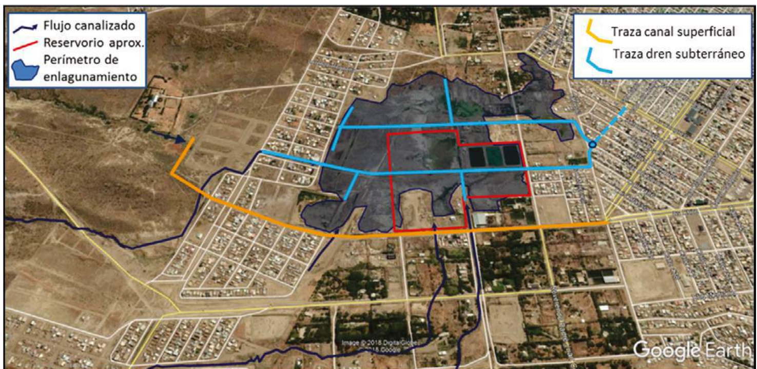
Figura 9. Vista aérea del sector con la ubicación del canal superficial colector (amarillo) y las dos ramas de drenes subterráneos (celeste), propuestos para deprimir el nivel freático.
